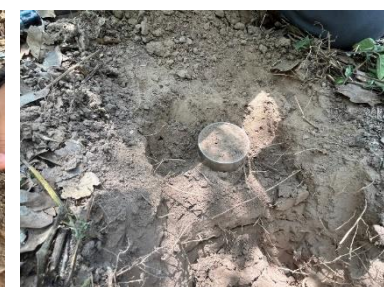
ภาพที่ ๒๑ เก็บตัวอย่างดินแบบไม่รบกวนโครงสร้างดิน สถานีพัฒนาที่ดินชัยนาท สำนักงานพัฒนาที่ดินเขต ๑
