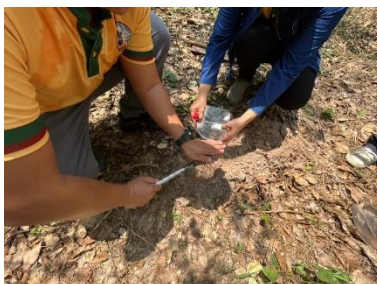
ภาพที่ ๒๐ เก็บตัวอย่างดินแบบรบกวนโครงสร้างดิน สถานีพัฒนาที่ดินชัยนาท สำนักงานพัฒนาที่ดินเขต ๑
