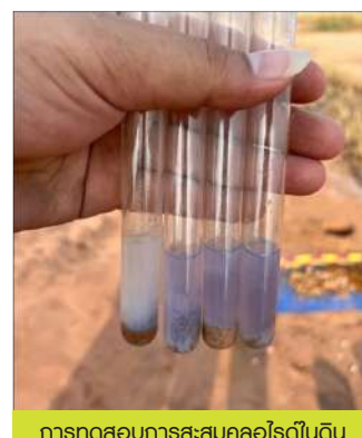
การทดสอบการสะสมคลอไรด์ในดิน ด้วยสารซิลเวอร์ไนเตรท
