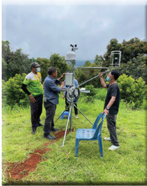
เครื่องมือตรวจวัดอากาศอัตโนมัติ
