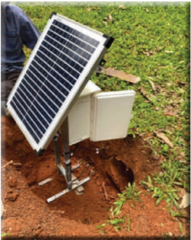
เครื่องมือวัดอุณหภูมิและความชื้นดิน
