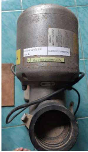
๗. เครื่องบดตัวอย่างดิน ยี่ห้อ Glenmills รหัสครุภัณฑ์ออนไลน์ ๖๖๓๐-๐๑๐-๐๑๔๒สพข.๑๑#๒
