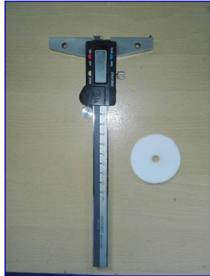
ภาพผนวกที่ 3 ท่อนสแตนเลส และเครื่องมือวัดระดับความลึก (electronic digital depth gauge)
