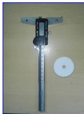
(ค) เตรียมอุปกรณ์ หนุมด (erosion stake) และ electronic digital depth gauge
