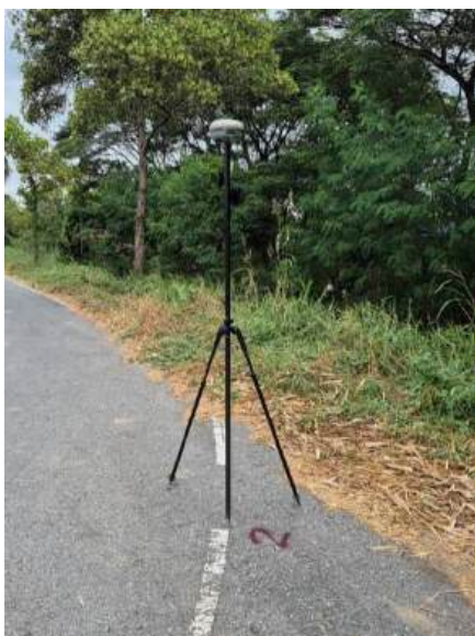
รูปที่ 13 แสดงการรังวัดจุดควบคุมภาคพื้นดิน และจุดตรวจสอบ
