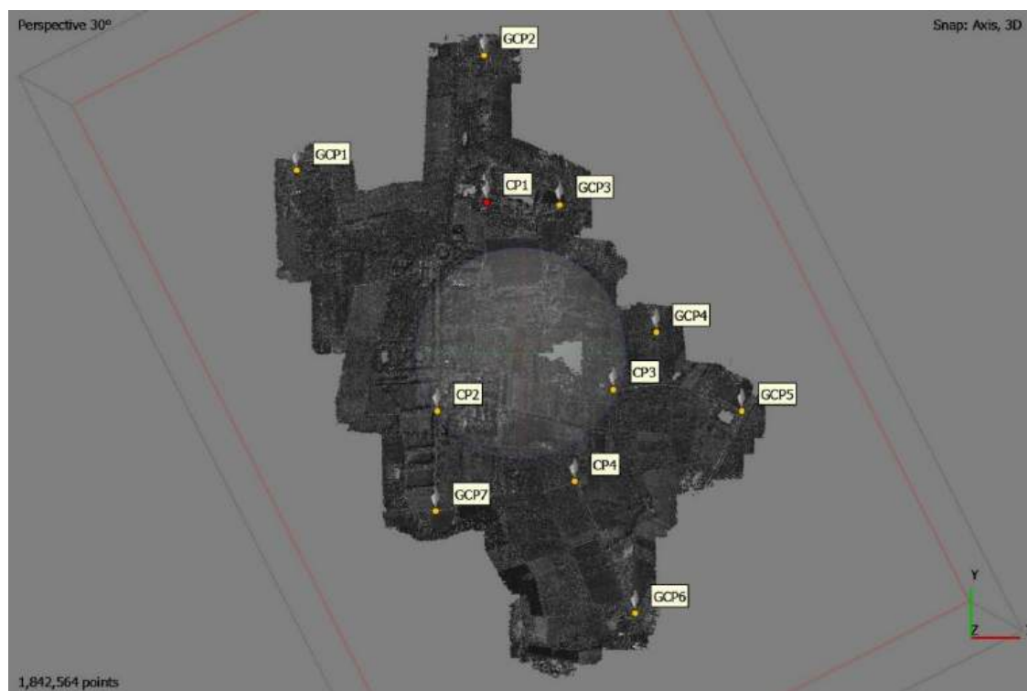
รูปที่ 34 แสดงการตรวจสอบความถูกต้องของภาพถ่ายหลายช่วงคลื่นเปรียบเทียบกับจุดตรวจสอบ
