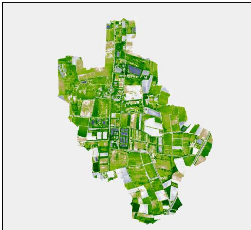
รูปที่ 48 แสดงภาพถ่ายหลายช่วงคลื่นและภาพถ่ายหลายช่วงคลื่นที่ทำ NDVI แล้ว
