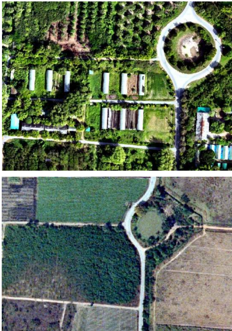
รูปที่ 47 แสดงภาพถ่ายออร์โธสตีที่ได้จากอากาศยานไร้คนขับ เมื่อเปรียบเทียบกับ ภาพถ่ายออร์โธสตี จากโครงการแผนที่ทรัพยากรของกระทรวงเกษตรและสหกรณ์ (MOAC) ปี 2545 มาตรฐาน 1:1,000
