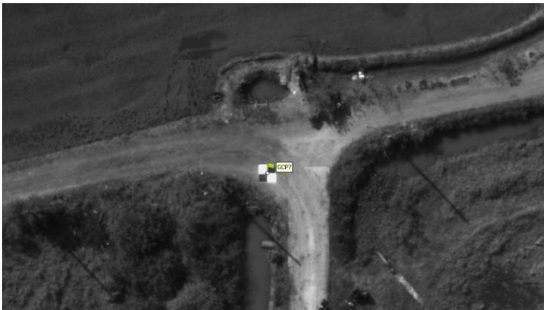
รูปที่ 22 แสดงการปรับแก้จุดควบคุมภาคพื้นดินในการประมวลผลภาพถ่ายหลายช่วงคลื่น
