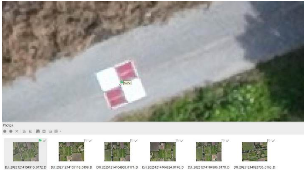
รูปที่ 21 แสดงการปรับแก้จุดควบคุมภาคพื้นดินในการประมวลผลภาพถ่ายออร์โธรี
