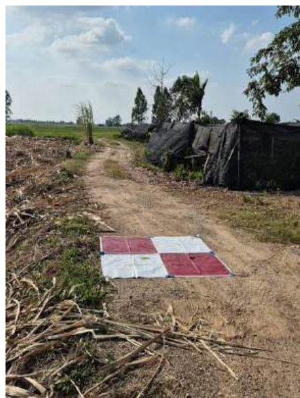
รูปที่ 13 แสดงการรังวัดจุดควบคุมภาคพื้นดิน และจุดตรวจสอบ
