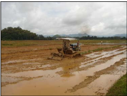
การทำเทือกนา โดยใช้รถดีเทือก ในพื้นที่ที่รถไถเดินตามไม่สามารถดำเนินการได้
