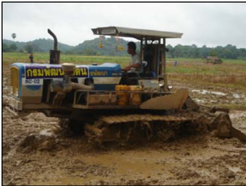
การทำเทือกนา โดยใช้รถดีเทือก ในพื้นที่ที่รถไถเดินตามไม่สามารถดำเนินการได้
