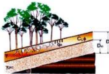
รูปที่ 10 แสดง infinite slope stability model
