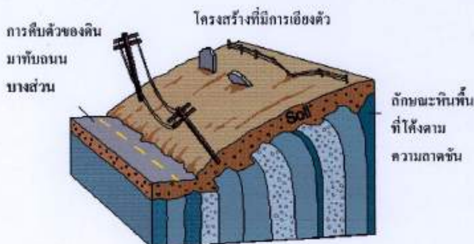
รูปที่ 3 ลักษณะของการเคลื่อนที่อย่างช้าๆ (การคืบตัว: Creep) (BC Geological Survey, 2006)
