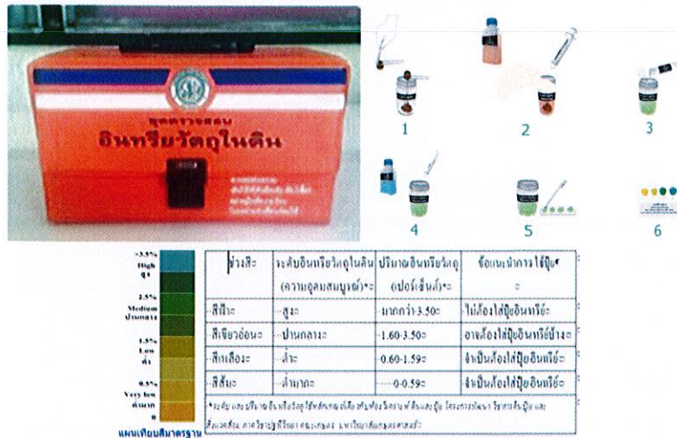
ภาพที่ 3 ชุดตรวจสอบอินทรีย์วัตถุในดินของมหาวิทยาลัยเกษตรศาสตร์ ขั้นตอน และแผ่นเทียบสีมาตรฐานตรวจหาปริมาณอินทรีย์วัตถุในดิน
